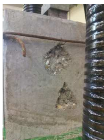
Fig.9: Campione dopo ulteriore carico distruttivo
