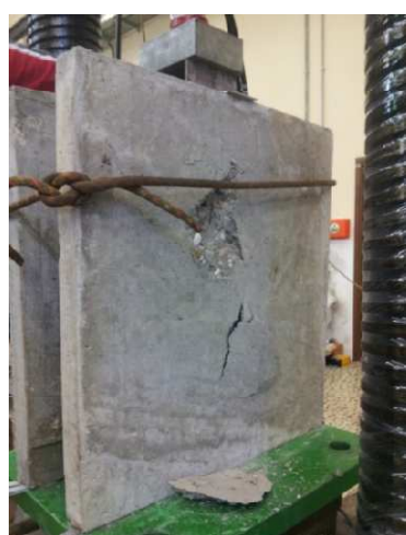
Fig.9: Campione dopo ulteriore carico distruttivo
