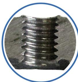
Il materiale di cui è composto è un acciaio ad alta resistenza, **superiore agli 800 MPa**, opportunamente lavorato nella parte inferiore con filetto **automaschiante** per l'ancoraggio meccanico nel profilo metallico e sagomato nella parte superiore per l'aggrappaggio alla cappa in cls.
