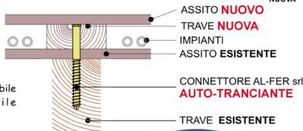
Il rinforzo di solai con **sistema legno-legno** è molto utilizzato nel restauro di edifici storici soprattutto laddove è riconosciuto un valore artistico, permette di recuperare la struttura esistente utilizzando lo stesso materiale d'origine.
